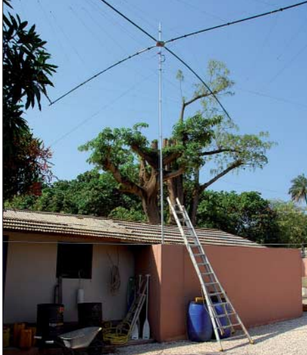
Der Spiderbeam für die zweite SSB-Station – das Band einen viel höheren Geräuschpegel aufwies.
