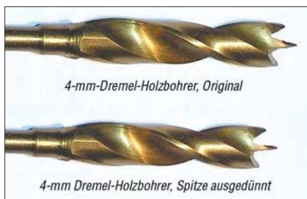
Bild 3: Dremel-Holzbohrer, oben un bearbeitet, unten bearbeitet
