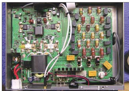
Bild 3: Durchführung der von den neuen Buchsen kommenden Kabel zur Unterseite
