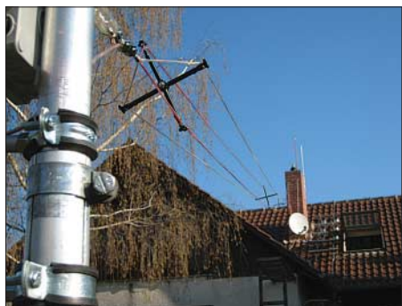
Bild 1: Vieradriger Zylinderreusenstrahler mit Spreizer SP-120
