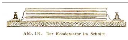
Bild 3: Ansicht des zusammengesetzten Kondensators im Schnitt
