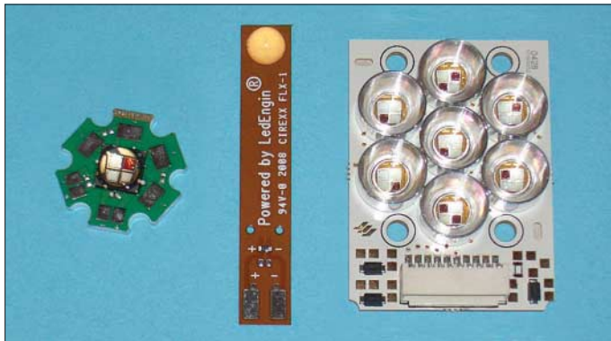
Bild 1: Schon heute stehen Power-LEDs mit 5, 15 und 30 W (v. l. n. r.) für energiesparende Beleuchtungen zur Verfügung.
