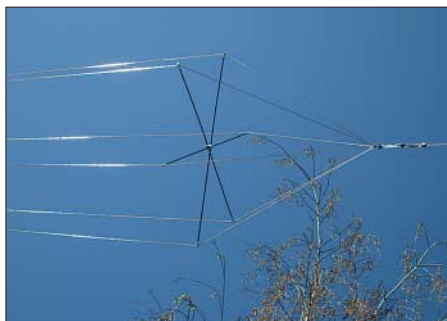
Bild 2: Sechsadriger Kegelreusenstrahler mit selbst gebautem Spreizer (1 m Durchmesser)
