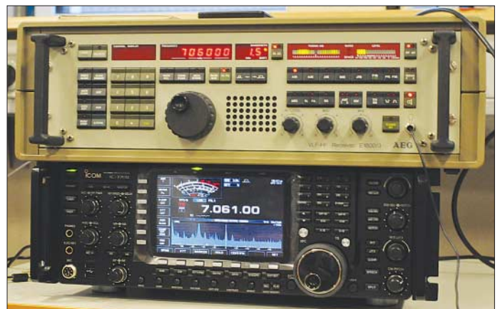
Bild 2: Alt gegen neu – wer ist der Großsignalfestere? Oben Telefunken E1800/3, unten Icom IC-7700
