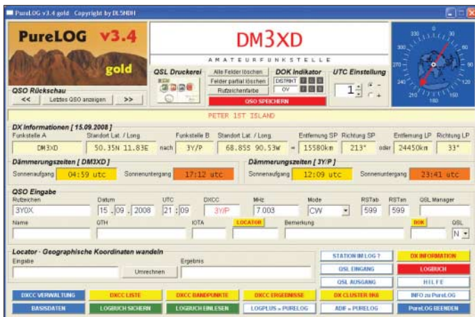
Bild 1: Hauptfenster des Logbuchprogramms PureLOG; über dieses Fenster sind auch alle Funktionen erreichbar.
