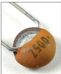
Bild 9: Eigentlich ein Produktionsfehler, aber didaktisch ein Glücksfall: Der nur teilweise aufgetragene Schutzlack offenbart den inneren Aufbau dieses keramischen Scheibenkondensators.
