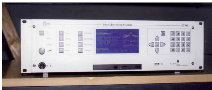
Techniker der Media Broadcast GmbH verwenden den DRM-Messempfänger DT700 des Fraunhofer-Institutes für Integrierte Schaltungen zur Überprüfung der DRM-Sender vor Ort.
