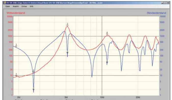
Bild 5: Impedanzverlauf am Kegelreusendipol; rot Wirk- und blau Blindwiderstand
